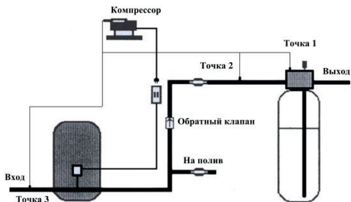
Рис.1 Варианты подачи воздуха в водопровод.
