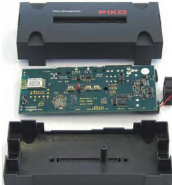
**Внимание!** Чтобы избежать коротких замыканий, для большей безопасности головки винтов рекомендуется изолировать с помощью скотча и т.п.
