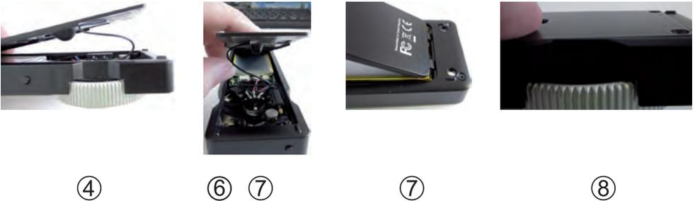
\* Если вдруг провод на крышке отделится от основания на печатной плате, просто вставьте его сверху опять на прежнее место. Небольшой разъем не имеет защиты от скрутки и поэтому его можно вставить под любым углом.
