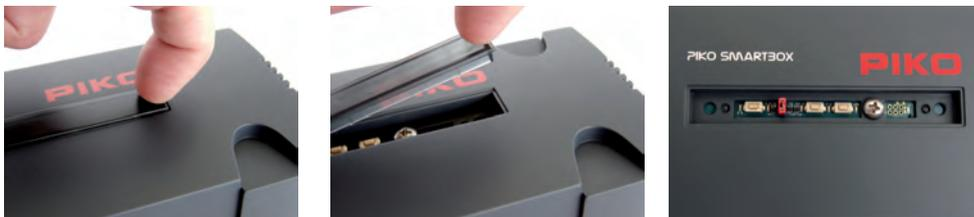
Следующим шагом, пожалуйста, осторожно извлеките материнскую плату PIKO SmartBox®, посредством её осторожного подъема вверх. Для этого лучше всего ухватиться через оба углубления для выемки, которые находятся справа и слева от платы. При этом учтите, что в нижней половине корпуса расположен вентилятор. Однако его можно вытащить вверх без приложения усилий, он лежит свободно.
