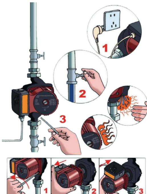
**ВНИМАНИЕ!!!** Если насос используется в системе отопления, есть риск получения ожогов как от корпуса насоса, так и перекачиваемой насосом средой!
