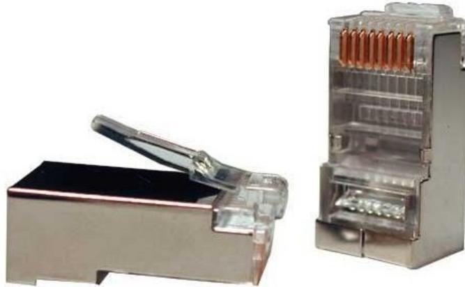
Коннектор RJ-45 FTP5е RIPO - это экранированный разъем стандартной категории 5Е. На данный момент является наиболее распространенным для экранированной витой пары. RJ-45 джек 8p8c экранированный оснащен фиксатором, надежно удерживающим провод в гнезде сетевого оборудования. Разъем RJ-45 FTP5е содержит конструкцию, которая предотвращает возможность короткого замыкания проводников кабеля.
