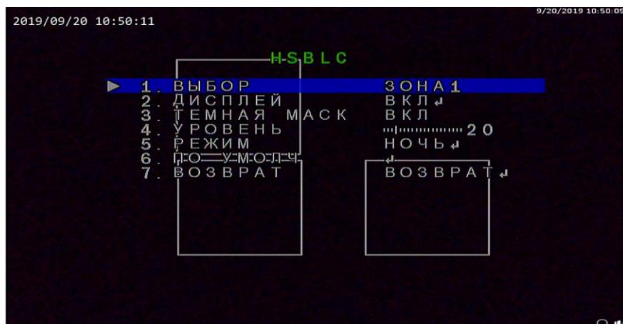
В камере предусмотрена возможность предустановки работы фильтров компенсации засветки отдельно для ночного и дневного изображения предусмотрено 4 зоны.
