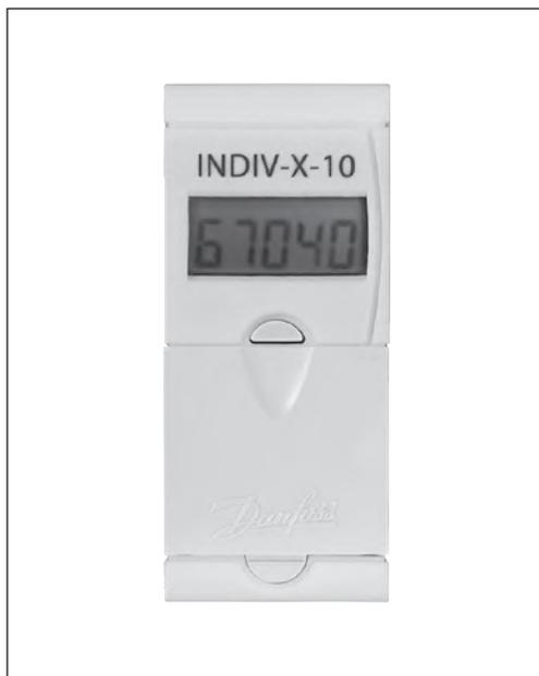
Распределитель INDIV-X-10 производит измерение и интегрирование по времени температурного напора между поверхностью отопительного прибора и воздухом в отапливаемом помещении. Результаты измерений используются для распределения потребления теплоты, зарегистрированного общедомовым прибором учета, между индивидуальными потребителями. На основе рассчитанных таким образом индивидуальных величин потребления производится начисление оплат за отопление для каждого потребителя.
