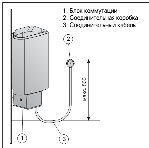
Рисунок 13. Установка каменки
