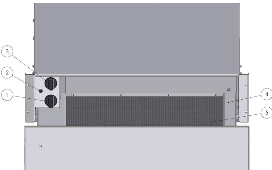
1. Таймер, переключатель пуска/остановки
