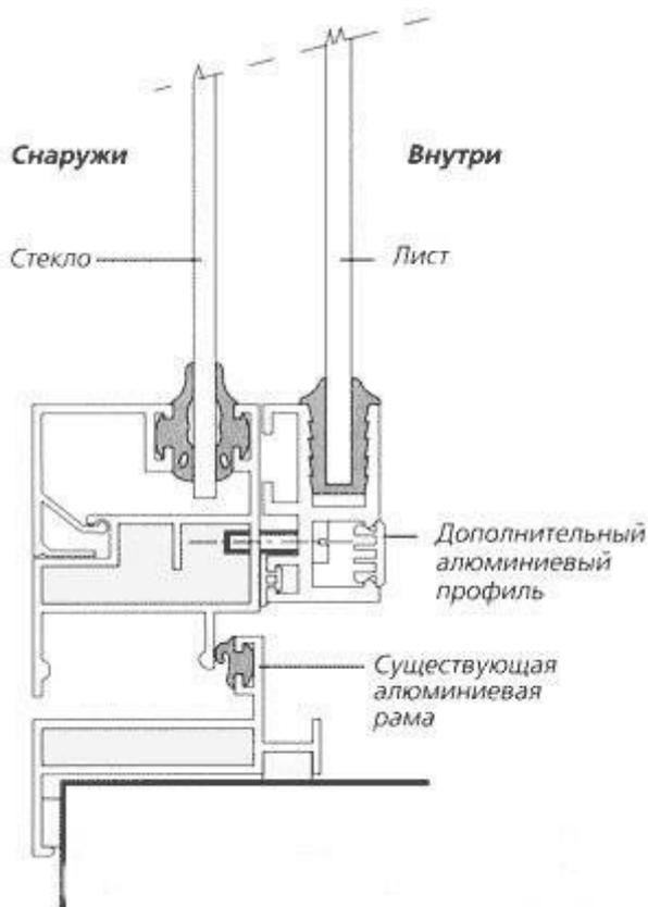
**Рис. 9. Внутреннее дополнительное остекление.**
