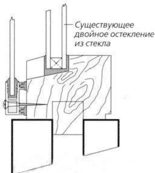
**Рис. 10. Внешнее дополнительное остекление.**
