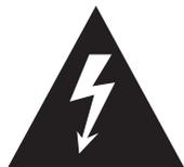
Значок молнии со стрелкой вниз внутри равностороннего треугольника предупреждает пользователя о наличии неизолированного «опасного напряжения» внутри продукта, которое имеет значительную величину для возможного риска поражения электрическим током человека.
