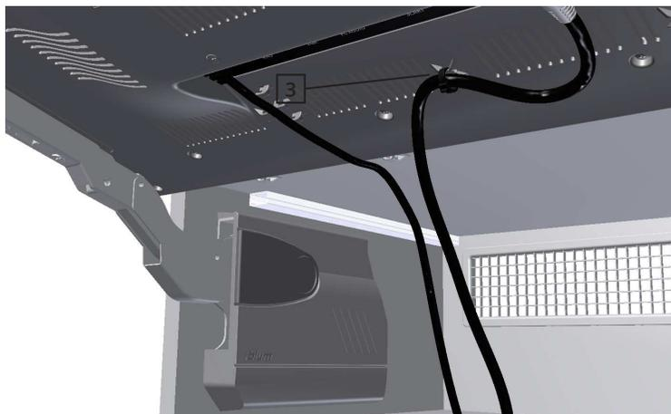
5. Закрепите кабеля хомутами-стяжками **3** к площадкам на потолке шкафчика. Затяните хомуты-стяжки так, чтобы кабели не могли свободно двигаться. Прочно затяните хомуты-стяжки.
