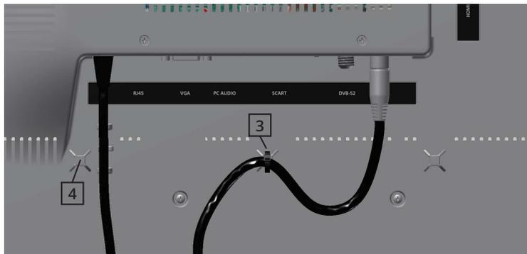
4. Закрепите кабели, как показано на рисунке. **4** Кабель подачи электроэнергии фиксируется хомутом-стяжкой к задней стенке телевизора. Остальные кабели фиксируются стяжками-хомутами **3** к соответствующим проемам.
