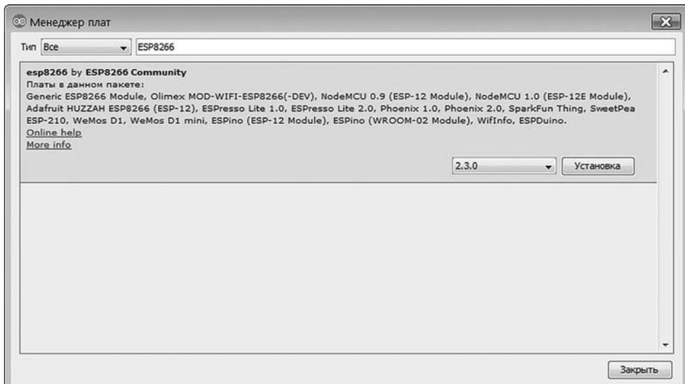
Рис. 1.3. Установка библиотеки `esp8266` в Менеджере плат Arduino IDE
