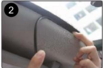
Подсоедините удлинитель выносной камеры (1) и Выносную камеру (2) к Устройству. Снимите обшивку автомобиля в требуемых местах (в зависимости от марки автомобиля) - стойка, накладка на порог.
