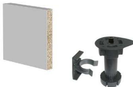
Цоколь крепится на регулируемую опору черного цвета из АБС-пластика при помощи клипсы. Опора регулируется от 100 до 115 мм.
