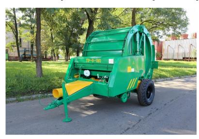
Пресс-подборщик рулонный безременной ПРФ-180 постоянной камерой прессования предназначен для подбора и прессования в рулоны сена естественных валков трав, соломы C Сеянных последующей обмоткой рулона шпагатом. Подача шпагата осуществляется с помощью электропривода. пресс-подборщик комплектуется
