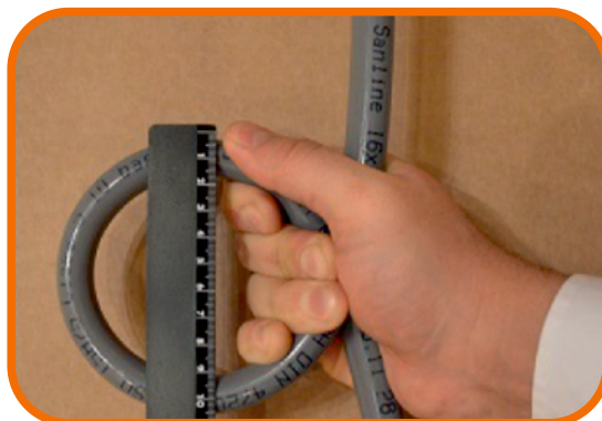
Отсутствие овализации и заламов. Радиус изгиба менее 4 диаметров трубы
