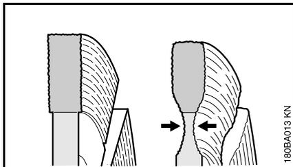
При резке дорожного полотна не следует проникать в несущий слой (часто щебень) – при этом может возникнуть чрезмерный износ сердечника – проникновение абразивно-отрезного круга в щебень можно распознать по светлой пыли – **опасность разрушения!**
