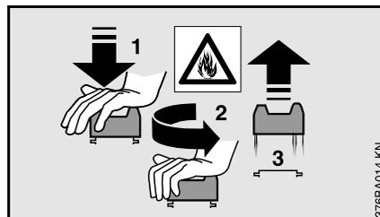
Ни в коем случае не открывать и не закрывать байонетный затвор крышки топливного бака с помощью инструмента. Это может привести к повреждению крышки и утечке топлива.
