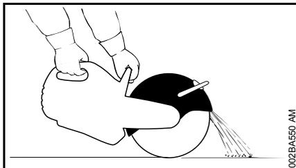
Правильно отрегулировать защиту абразивно-отрезного круга: частицы снимаемого материала должны отводиться в сторону от пользователя и агрегата.
