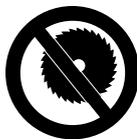
Запрещается применять пильные диски, твердосплавные, спасательные, дереворежущие или иные зубчатые инструменты – **опасность получения смертельной травмы!** В противоположность равномерному съему частиц при эксплуатации абразивно-отрезных дисков, зубья пильного диска с долообразными зубьями при резке могут застрять в материале. Это способствует агрессивной резке, что может привести к возникновению неконтролируемых, чрезвычайно опасных реактивных сил (обратный удар) агрегата.
