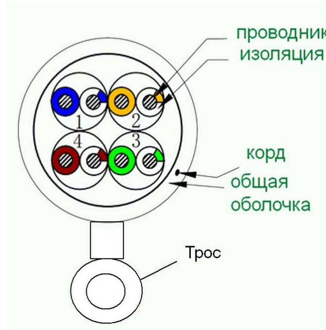
Кабель применяется для построения локальных сетей 10BASE-T, 100BASE-TX и 1000BASE-T и для прокладки телефонных линий, поддерживает скорость передачи данных до 100 Мбит/с при использовании 2 пар и до 1000 Мбит/с при использовании 4 пар. Используется в видеонаблюдении, для подключения аналоговых и IP видеокамер.
