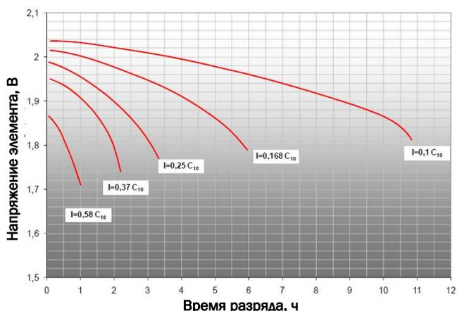
Рис. 1 Стандартные кривые разряда для батарей GEL FIAMM
