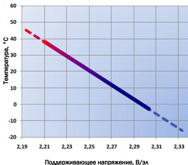
Рис. 6 Рекомендуемое поддерживающее напряжение при различных температурах
