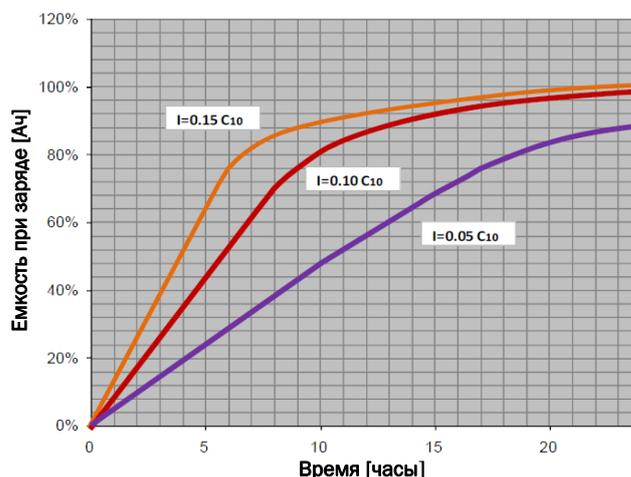
Рис. 7 Кривые заряда при напряжении 2,4 В/эл. с различными пределами тока
