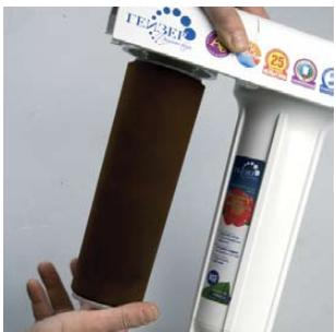
Ключом донной заглушки вывернуть у картриджа донную заглушку (рис. 1) и вынуть использованный дозатор (рис. 2).
