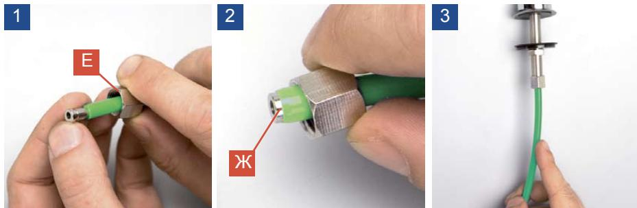
В гайку (**Е**) проденьте пластиковую трубку (рис. 1). Пистон (**Ж**) вставьте внутрь трубы до упора (рис. 2). Закрутите на резьбовой шток крана гайку (рис. 3).
