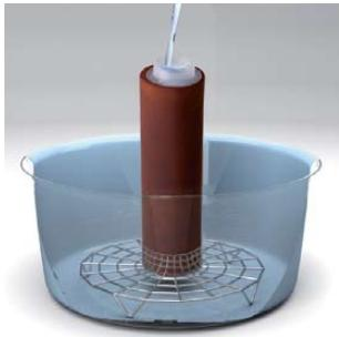
Поставить картридж вертикально в мойку и пролить оставшийся раствор, заливая внутрь через резьбовую горловину и дать полностью стечь.
