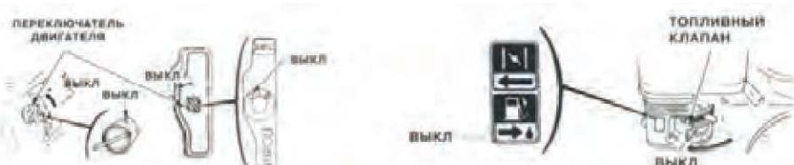
3. Поверните топливный клапан в позицию "Выключить" (OFF),
