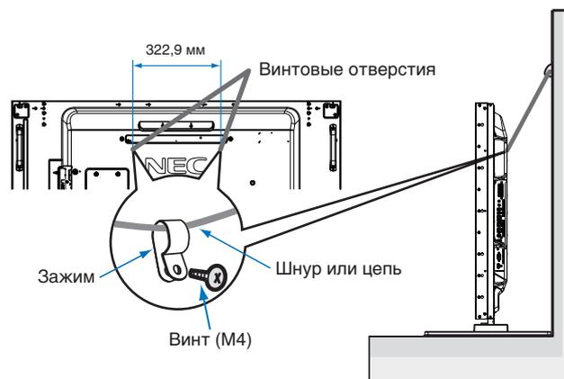
Перед креплением монитора к стене убедитесь, что стена может выдержать вес монитора.
