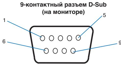
В этом мониторе используются строки RXD, TXD и GND для управления RS-232C.
