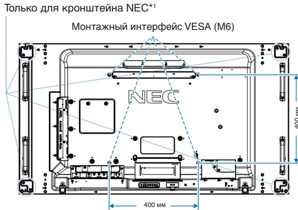
Кронштейны можно прикрепить к монитору, когда он повернут вниз лицевой стороной. Чтобы избежать царапин ЖК-панели, перед размещением монитора на столе экраном вниз на стол необходимо положить мягкую ткань, например полотенце, чья площадь будет превышать площадь экрана монитора. Убедитесь, что на столе отсутствуют предметы, которые могут повредить монитор.
