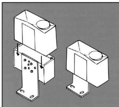
В случае постоянного сильного воздействия воды на корпус следует использовать корпус, отвечающий нормам IP 55. Для простых моделей номер кода 060-033066, для сдвоенных — 060-0350066.
