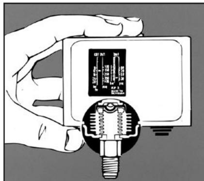
Для низкотемпературных установок, в которых прессостат, устанавливаемый за испарителем, должен обеспечивать безопасность (а не только контроль), используйте КР2 с небольшим диапазоном регулирования. Пример с прессостатом и термостатом, объединенными в один узел при серийном производстве:
