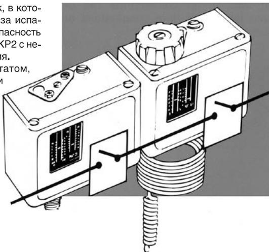
Для установок, в которых прессостаты серии КР работают очень редко (например, для выдачи сигнала тревоги) или выполняют функции датчиков-излучателей для программируемых автоматов типа HLC или им подобных, мы рекомендуем использовать **КР с золотыми пластинчатыми контактами**. Они обеспечивают надежный контакт при очень низких напряжениях.
