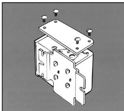
В случае установки прессостатов в сильно загрязненных или чересчур влажных помещениях (брызги воды сверху и со всех сторон), прессостаты защищаются специальными кожухами (номер кода 060-105666 — для простых моделей и 060-105566 — для сдвоенных), которые приспособлены для углового и настенного крепления.
