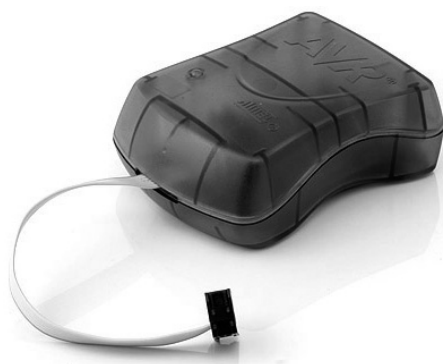
Рис. 1.2. AVR программатор ISP MKII
