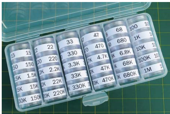
Рис. О.14. Коробки несколько большего размера хорошо подходят для хранения резисторов — если слегка укоротить их выводы
