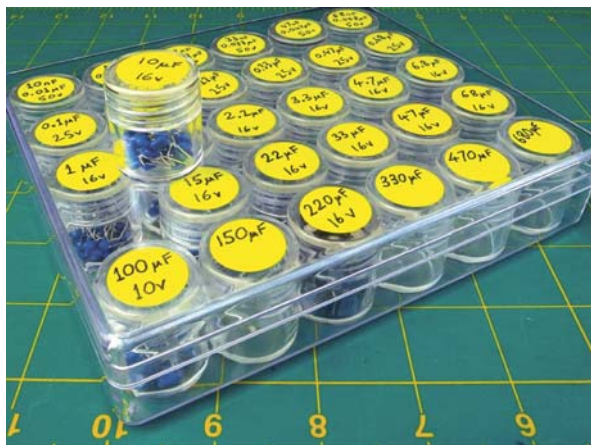
Рис. О.13. Современные многослойные керамические конденсаторы имеют настолько маленький размер, что для их хранения идеально подходят контейнеры, первоначально предназначенные для хранения бусин
