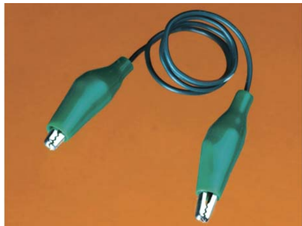
Рис. О.11. Отрезок провода с «крокодилами» на концах можно использовать вместо мини-клипс. Один «крокодил» закрепляется на наконечнике щупа, а другой — на каком-либо проводе или в точке проверяемой схемы
