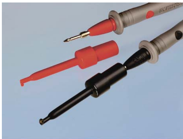
Рис. О.8. Мини-клипсы надеваются на щупы мультиметра, чтобы их можно было прикрепить к проводнику, освобождая вас от необходимости удерживать их самому
