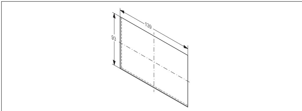
При монтаже регулятора ECL Comfort 110 толщина панели щита управления не должна быть более 5 мм. Для фиксации регулятора в вырезе применяется специальная скоба (кодированный номер 087B1249) .
