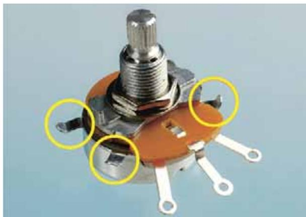
Рис. 1.45. Лапки потенциометра отогнуты вверх и наружу
