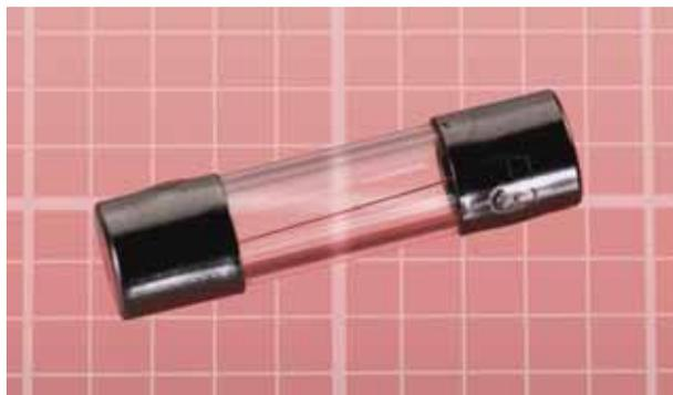
Рис. 1.13. Патронный стеклянный предохранитель сложнее захватить зажимами «крокодил»
