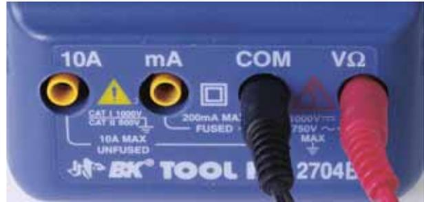
Рис. 1.18. Обратите внимание на маркировку гнезд этого мультиметра
