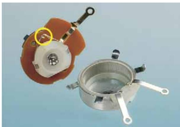
Рис. 1.46. Корпус потенциометра разобран (кружком выделен движок)
