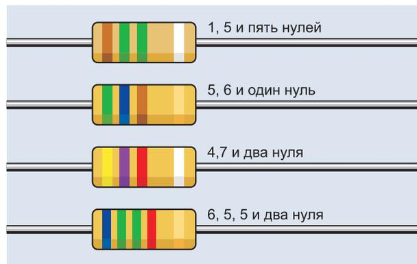
Рис. ЦВ-1.41. Четыре примера цветовой маркировки резистора
