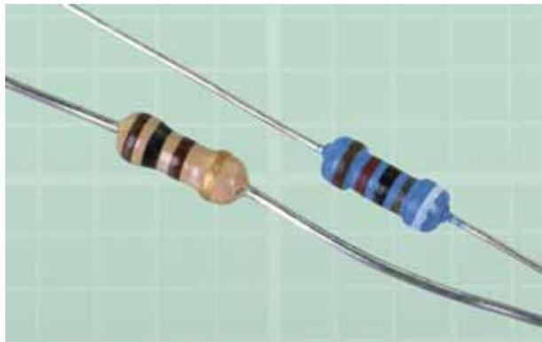
Рис. 1.15. Два подходящих резистора мощностью 0,25 Вт
