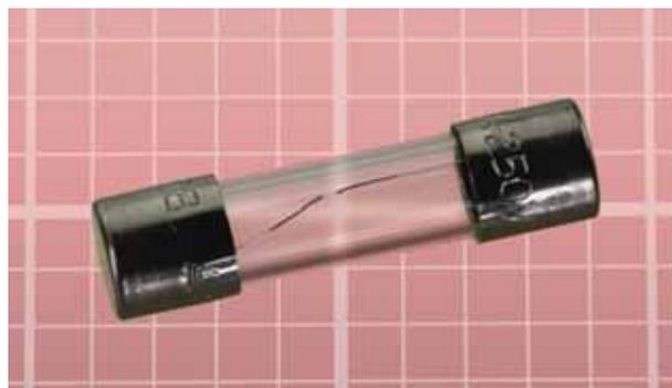
Рис. 1.35. В перегоревшем патронном предохранителе появляется аналогичный разрыв
