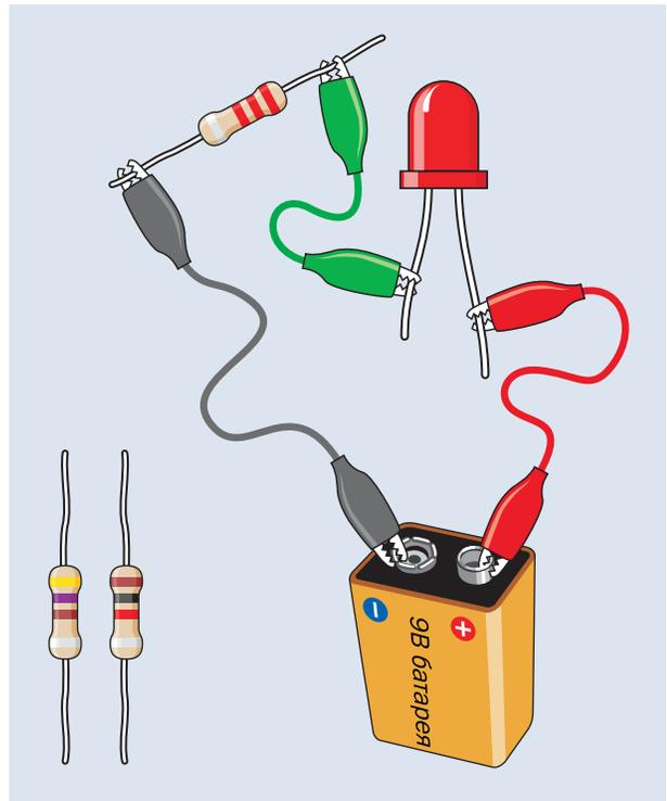
Рис. 1.42. Ваша первая электрическая схема, включающая светодиод
