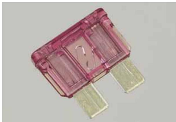
Рис. 1.34. Обратите внимание на разрыв плавкой вставки
