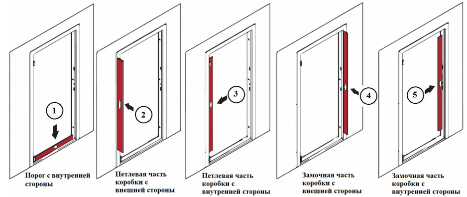
Рис. 8 Схема контрольных замеров дверного блока уровнями
