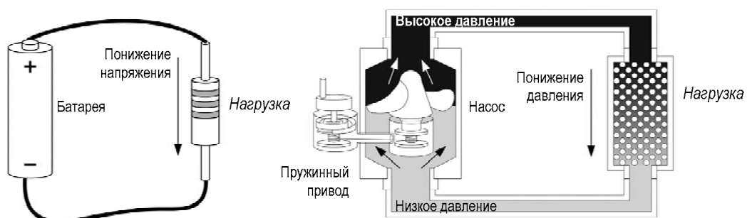
РИС. 2.11. Объяснение электрического тока аналогией с течением воды
