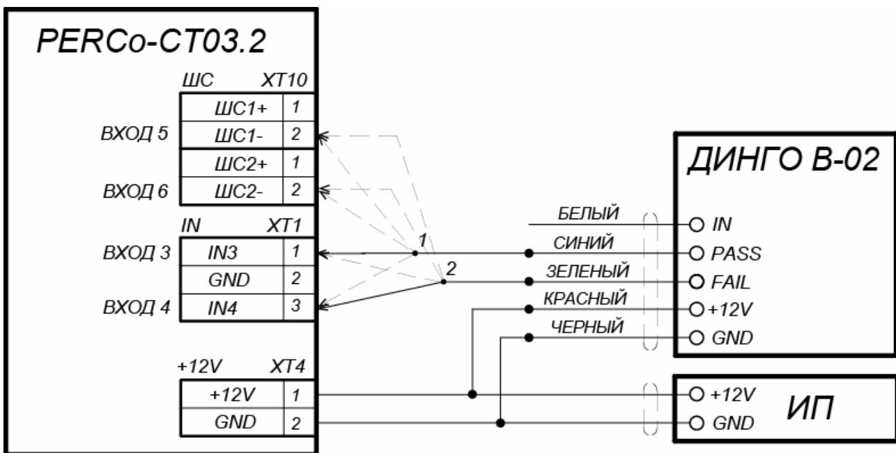
Рисунок 15. Схема подключения алкотестера «Динго В-02» (ООО СИМС-2)
