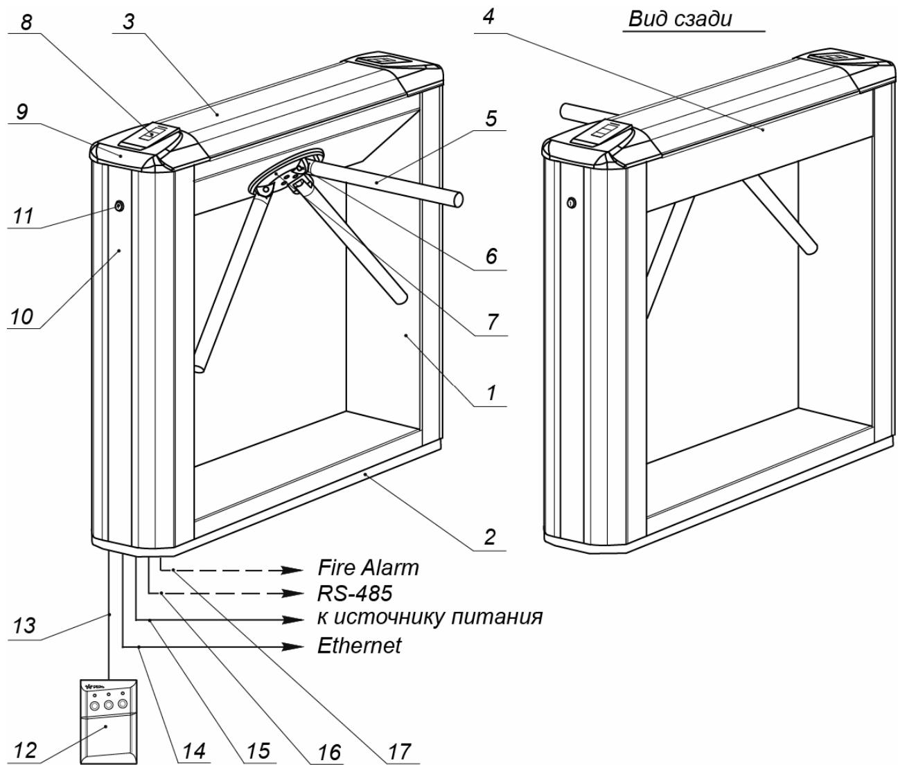
**Рисунок 2. Устройство ЭП**
