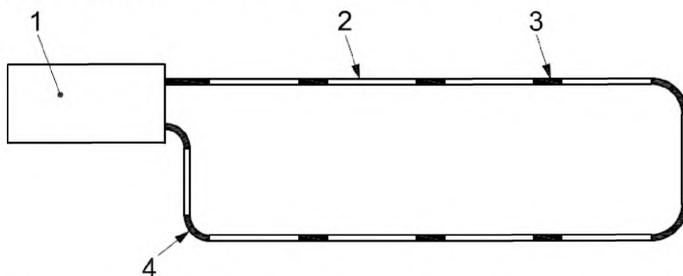
1 – ротационный насос и система нагрева; 2 – отрезки труб из PVC-C тип I длиной 300 мм;
