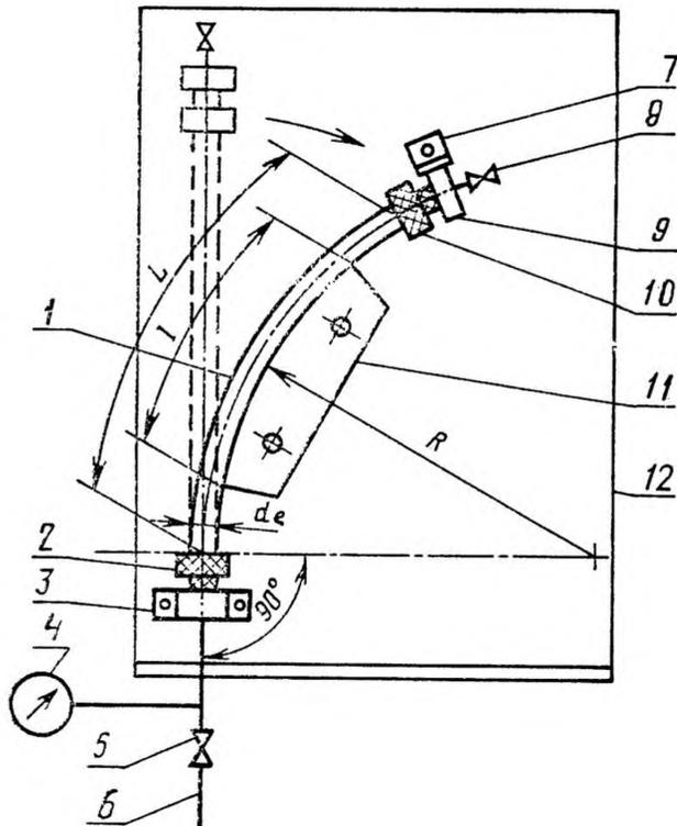
1 – труба; 2 – испытуемое соединение и фитинг; 3 – соединительный ниппель; 4 – манометр; 5 – кран; 6 – источник гидростатического давления; 7 – фиксатор; 8 – воздушный клапан; 9 – концевой ниппель; 10 – фитинг; 11 – шаблон для задания радиуса изгиба; 12 – рама для крепления
