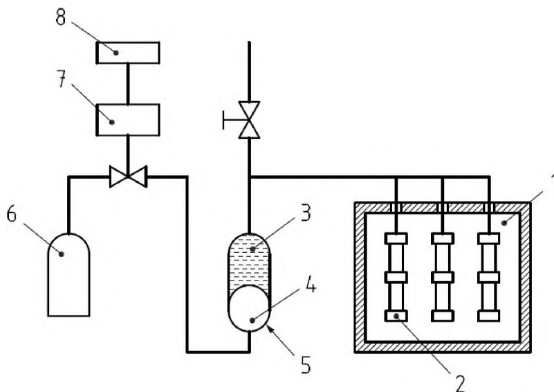
1 – камера или помещение с контролируемой температурой; 2 – образцы для испытаний; 3 – вода; 4 – воздух; 5 – преобразователь давления; 6 – баллон со сжатым воздухом; 7 – клапан; 8 – электрическое управление
