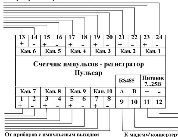
Подключение активных выходных цепей должно производиться при отсутствии напряжения питания.
