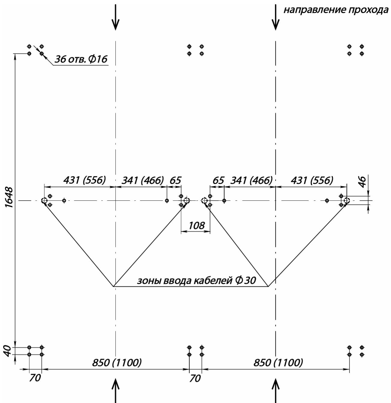
Рисунок 15. Схема разметки для монтажа турникета и двусторонней секции
