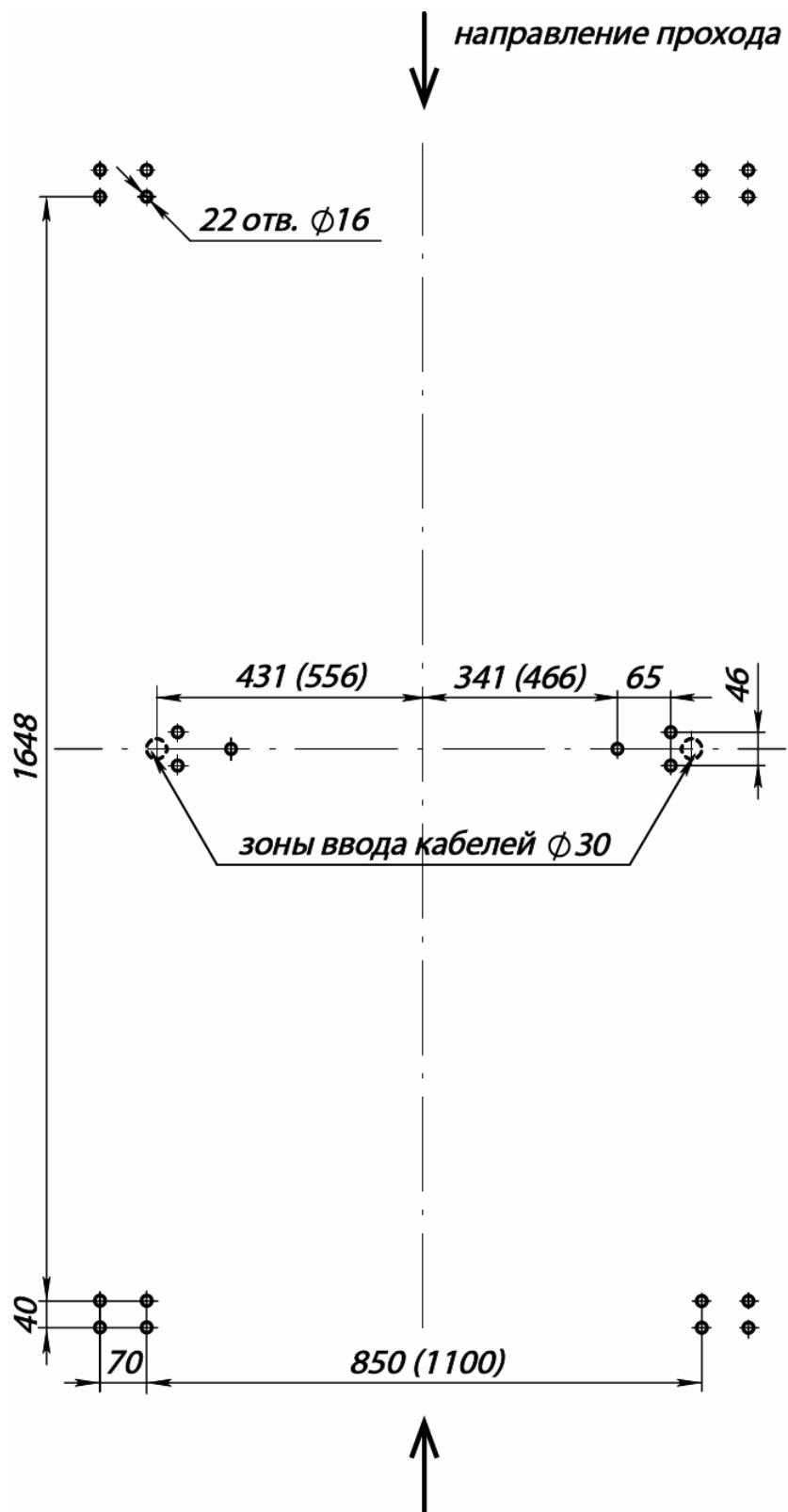
Рисунок 14. Схема разметки для монтажа турникета
