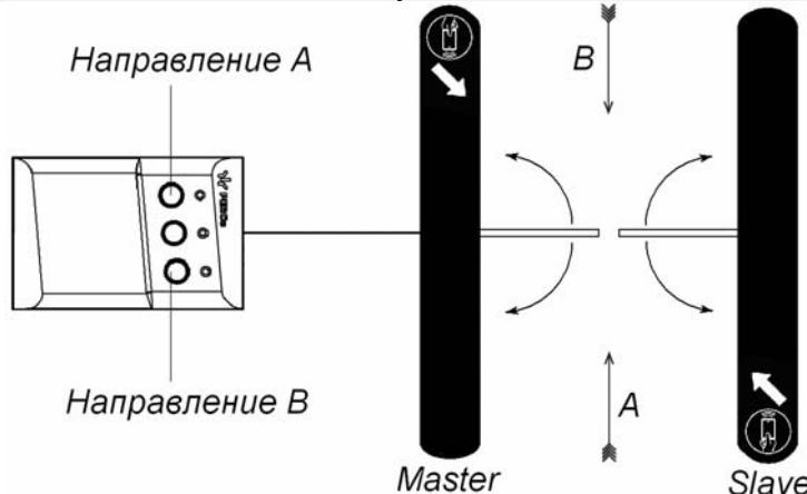
**Рисунок 11. Стандартная ориентация ПДУ относительно секций турникета**
