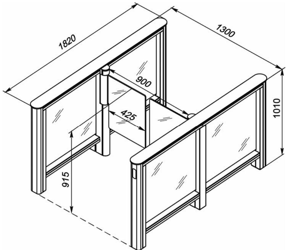
Рисунок 3. Габаритные размеры турникета со створками PERCo-ATG-425
