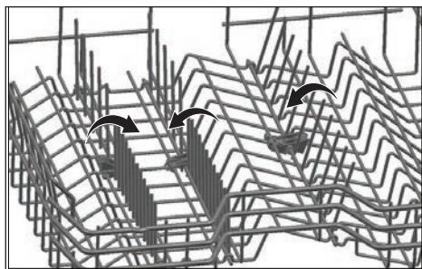
**i** Если приводить сетки в горизонтальное положение, держа их за края, их можно случайно согнуть. Поэтому, переводя их в горизонтальное или вертикальное положения, держите сетки за их ручки
