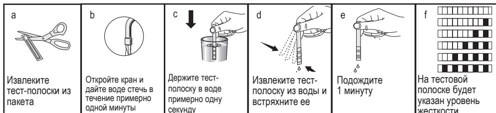
После определения жесткости водопроводной воды:
