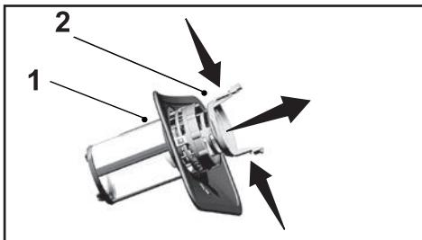
4. С помощью щетки промойте все три фильтра под проточной водой.
