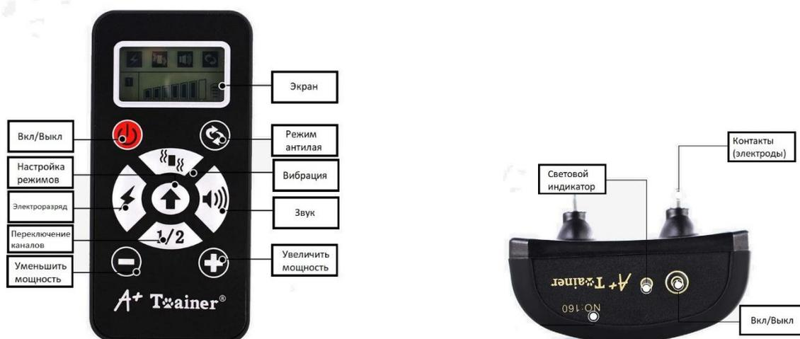
1. На экране отображаются разные режимы работы устройства, 2 канала и уровень заряда батареи.
