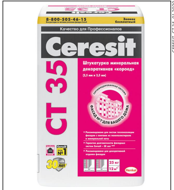
мешивании, добиваясь получения однородной массы без комков. Перемешивание производят миксером или дрелью с насадкой при скорости вращения 400–800 об/мин. Затем выдерживают технологическую паузу около 5 минут для созревания смеси и перемешивают еще раз. Смесь должна быть израсходована в течение 1 часа с момента приготовления. Консистенцию следует поддерживать только путем повторного перемешивания смеси, не добавляя воду! При работе использовать только нержавеющие емкости и инструменты!
