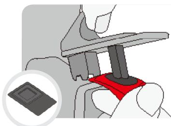
Откройте клапан, придерживайте его с одной стороны и снимите силиконовую крышку с другой стороны, чтобы разобрать.
