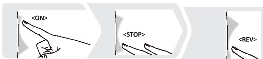
При чередовании использования кнопок реверса [REV] и прямого хода [ON] каждый раз перед сменой направления вращения всегда дожидайтесь, пока шнек полностью остановится. Двигатель соковыжималки не может остановиться мгновенно, и после установки переключателя в положение [STOP] шнек будет вращаться по инерции, плавно останавливаясь в течение 2-3 секунд. Как только шнек остановился, вы можете нажать кнопку для запуска вращения шнека в любую из сторон.
