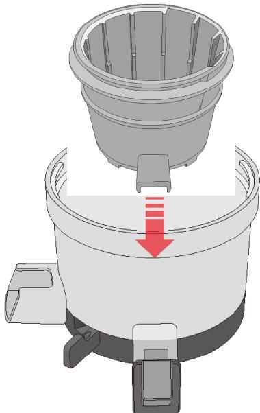
**2** Вставьте шнек в насадку-измельчитель до упора.
