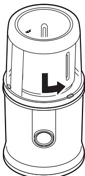
4. Закройте крышку уплотнения на базовой станции. Обратите внимание на положение направляющих штифтов на крышке уплотнения и углублений на базовой станции.
