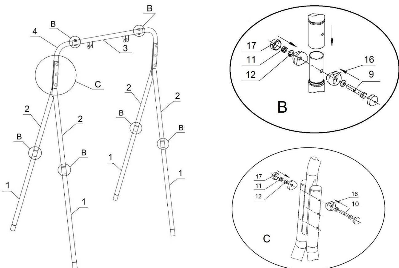
3.6. На нижние стойки качелей (поз.1) установить распорные перекладины (поз. 7/1), используйте крепеж поз. 10/1,11,12 и пластик поз. 16,17,18.
