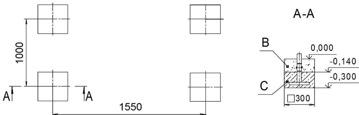
**Внимание:** размеры, указанные на рисунке предназначены для планирования площадки и могут незначительно отличаться от фактических размеров собранных Качелей, производить работы по бетонированию опор следует исходя из размеров собранных Качелей.
