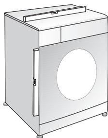
**!** **ПРЕДУПРЕЖДЕНИЕ:** Чтобы стиральная машина работала тихо и без вибрации, она должна стоять ровно и устойчиво. Выровняйте машину, отрегулировав высоту ножек. Если этого не сделать, машина может сдвинуться со своего места, что приведет к повышенной вибрации и повреждениям.
