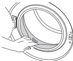
После каждой стирки проверяйте барабан на наличие посторонних предметов. Если показанные на рисунке отверстия заблокированы, очистите их с помощью зубочистки.
