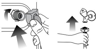
2. Затяните все гайки вручную. Не используйте для затяжки гаек гаечный ключ.
