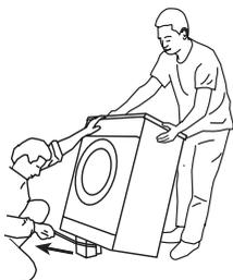
Чтобы удалить упаковочные крепления, наклоните машину назад и потяните за ленту.
