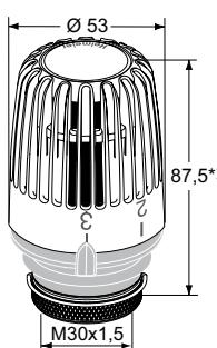
**Модель для установки в общественных местах. Защита от кражи при помощи предохранительного кольца. Ограничение диапазона настройки.**
