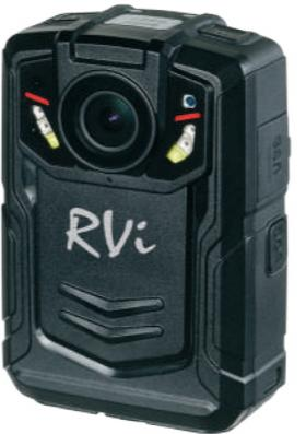
**Индивидуальный видеорегистратор RVi-BR-520** предназначен для ведения доказательной видеозаписи непосредственными участниками события с возможностью онлайн трансляции.
