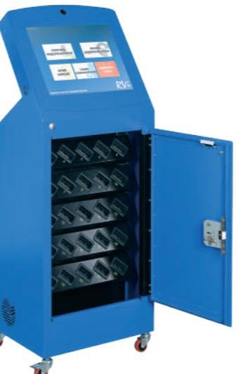
**Терминал архивации, зарядки и хранения данных RVi-TW-01** предназначен для автоматического переноса данных с индивидуальных видеорегистраторов на встроенное хранилище информации для обеспечения их последующего просмотра, длительного хранения, а также для построения отчетов.
