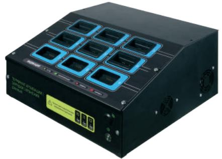
**Терминал архивации настольный RVi-TM01 (8Тб)** предназначен для автоматического переноса данных с индивидуальных видеорегистраторов на встроенное хранилище информации для обеспечения их последующего просмотра, хранения, а также для построения отчетов.
