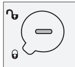
Предохранительная защелка, не допускающая открытия отсека детьми, не активирована
