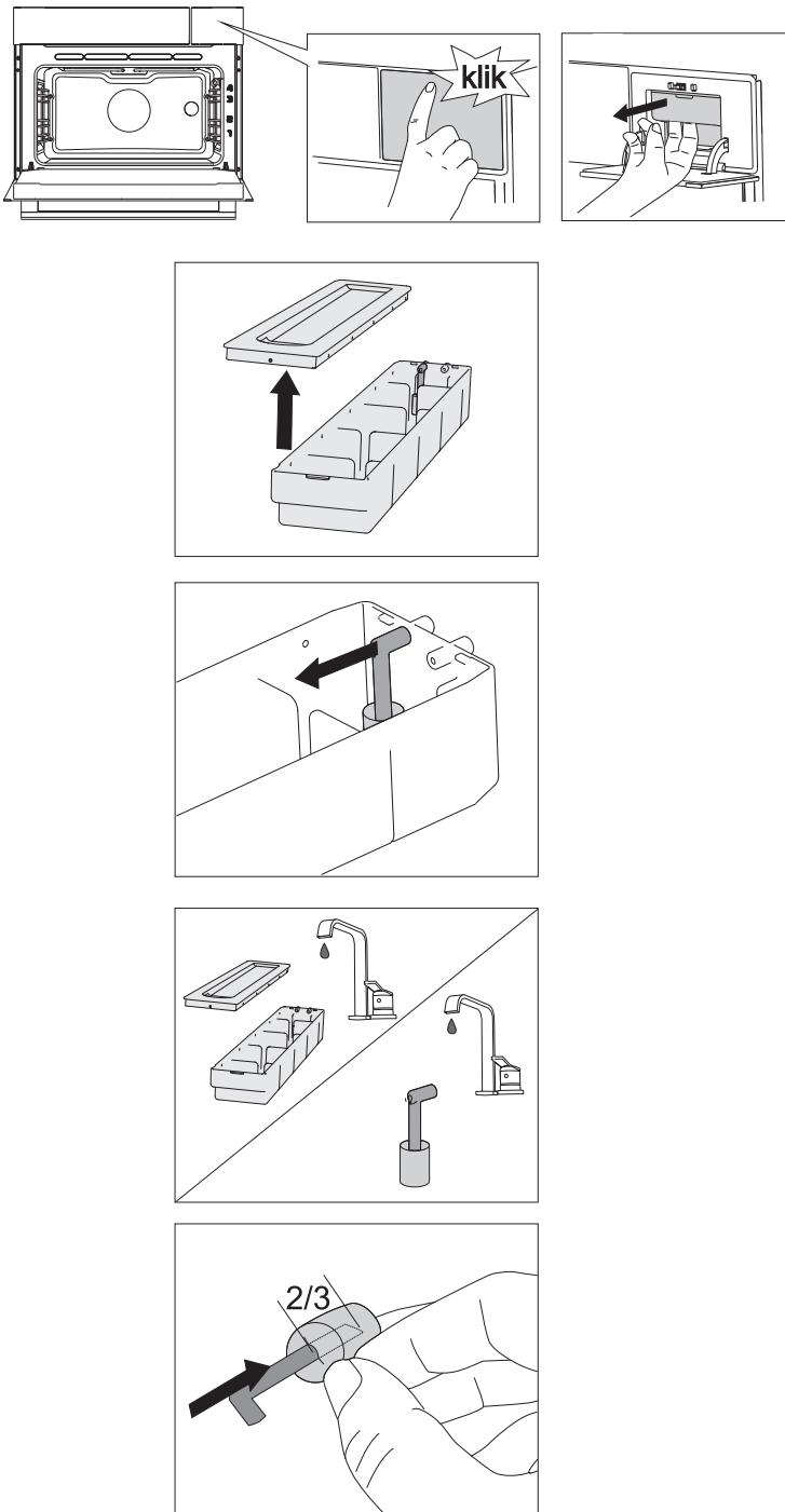
**1** Снимите крышку резервуара.
