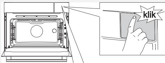
**1** Откройте крышку отсека резервуара, нажав на нее (в области наклейки).
