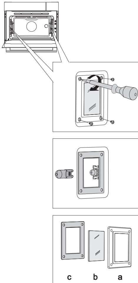
**1** Открутите четыре винта на крышке. Снимите крышку.
