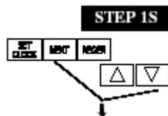
Нажмите одновременно на 3 секунды кнопки «NEXT» и «▼» и затем отпустите. Если в течении 5-ти секунд не произойдет перехода к шагу №2 – управляющий клапан будет заблокирован. Чтобы снять блокировку следует нажать кнопки: ▼, NEXT, ▲, SET CLOCK в указанной последовательности. Затем нажмите одновременно в течении 3-х секунд кнопки «NEXT» и «▼» и отпустите их.
