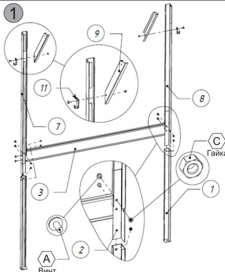
1. Соедините между собой стойку крыши (левую и правую) (7 и 8) с царгой (3) и уголком прижимным (2) при помощи винтов M6x12 DIN 967(A) и гаек M6 DIN 934 (C). Затем к полученному основанию присоедините стойки с подпятником (1).
