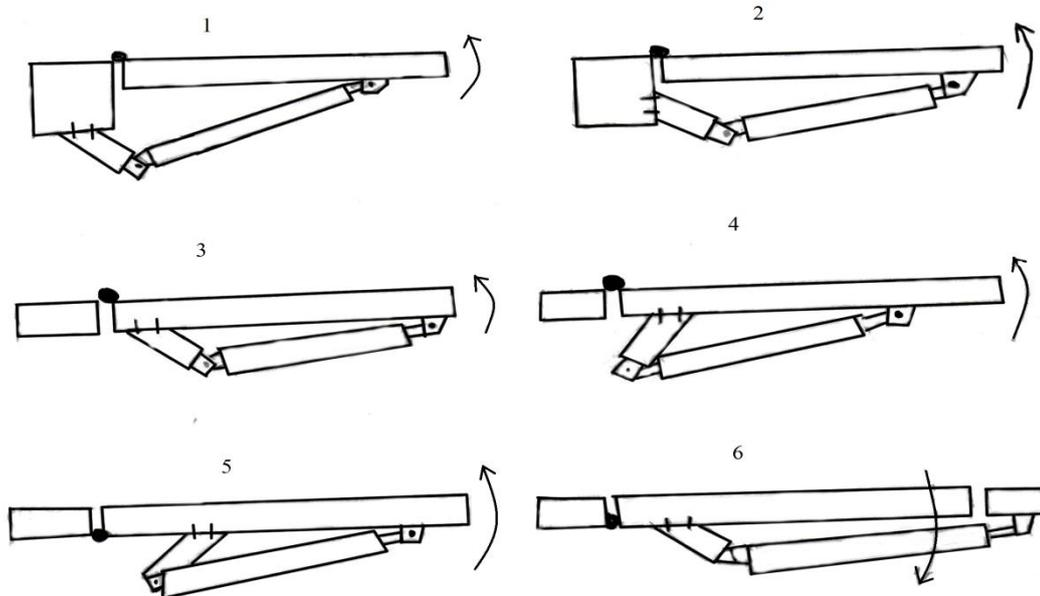
На рис.1 и рис.2 схематично показана установка доводчика на вертикальную стойку, на рис.3 и рис.4 - монтаж на горизонтальную перекладину. На рис.5 показан случай когда дверь открывается внутрь, при этом надо учесть, что кронштейн крепится к горизонтальной перекладине, а консоль к двери. На рис. 6 дверь тоже открывается внутрь, но отсутствует горизонтальная перекладина
