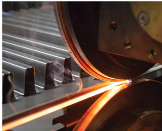
Сварка продольных швов панелей радиатора
