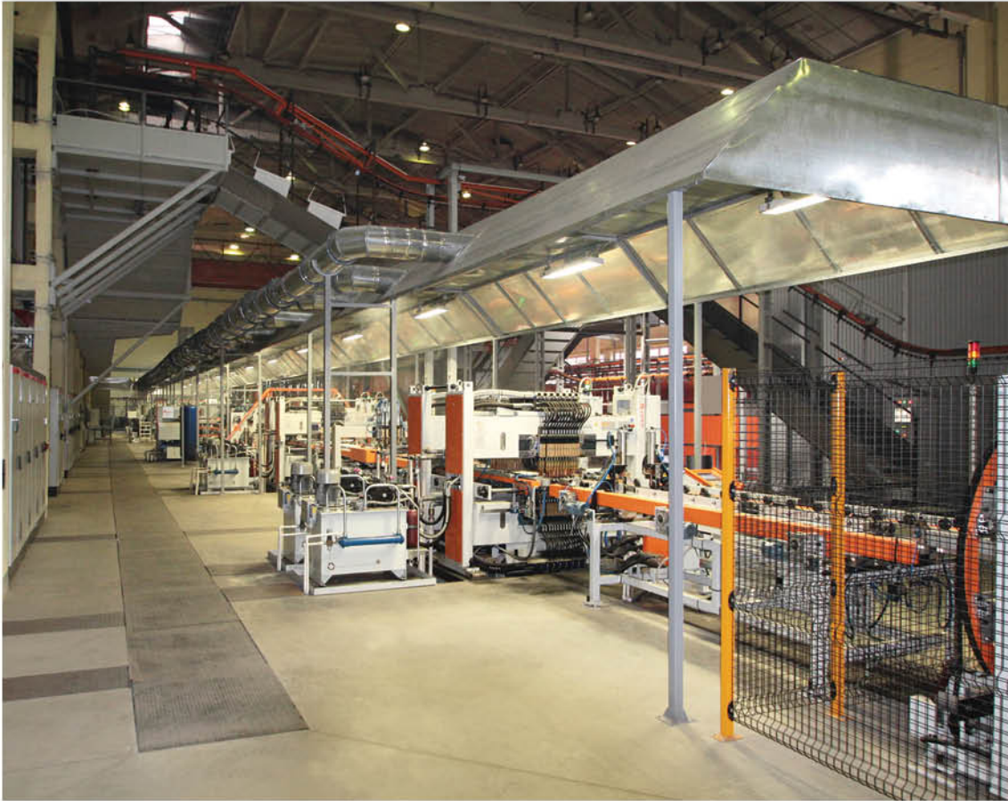
Новая современная автоматизированная линия сварки радиаторов «PRADO»
