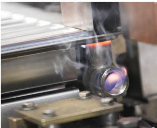
Сварка патрубков и гарнитуры
