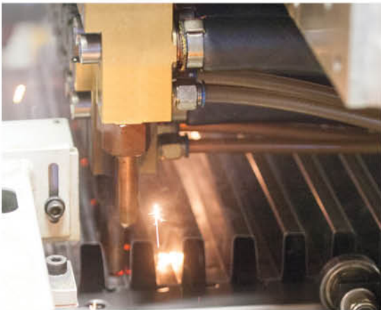
Сварка конвекционного листа с панелью радиатора
