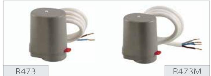
Электрические приводы серии R473 – нормально закрытые (НЗ); обеспечивают открытие клапана и гидравлическую циркуляцию контуров при подаче напряжения, снабжены двухпроводным кабелем для подсоединения к комнатным термостатам или регуляторам температуры.
