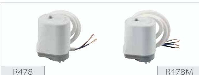
Электротермические приводы серии R478 являются нормально открытыми. Они обеспечивают открытие клапана и гидравлическую циркуляцию контуров в отсутствие электрического тока и снабжены двухпроводным кабелем для подсоединения к комнатным термостатам или регуляторам температуры. Модификация R478M снабжена микровыключателем конца хода для пусковых реле или отключающих клапанов.
