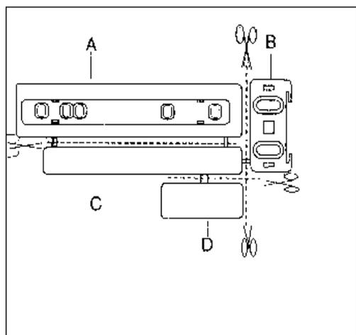
4. Поместите направляющую (А) на внутреннюю часть мебельной двери сверху и снизу, как показано на рисунке, и отметьте положение внешних отверстий. Прodelайте с помощью дрели отверстия и закрепите направляющие с помощью шурупов, входящих в комплект поставки.
