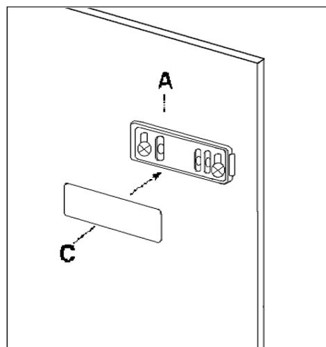
6. Откройте дверь прибора и дверь предмета мебели под углом 90°. Вставьте маленький прямоугольник (В) в направляющую (А). Соедините дверь прибора и дверь предмета мебели и отметьте место для отверстий, как это показано на рисунке.
