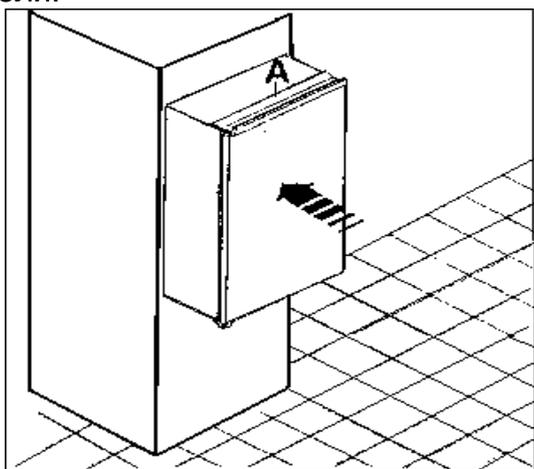
2. Откройте дверцу прибора и подвиньте его к стенке мебели на противоположной от петель стороне. Прикрепите прибор при помощи 4 шурупов, входящих в комплект поставки.
