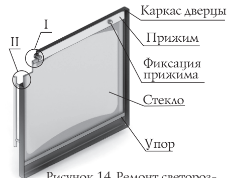
Рисунок 14. Ремонт светорозрачного экрана дверцы печи «Витрувия»
